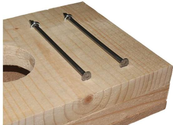
Jetzt legen wir die Brücke zwischen die Nägel und bohren die Löcher an den Seiten vor (diesmal ohne Senker).
